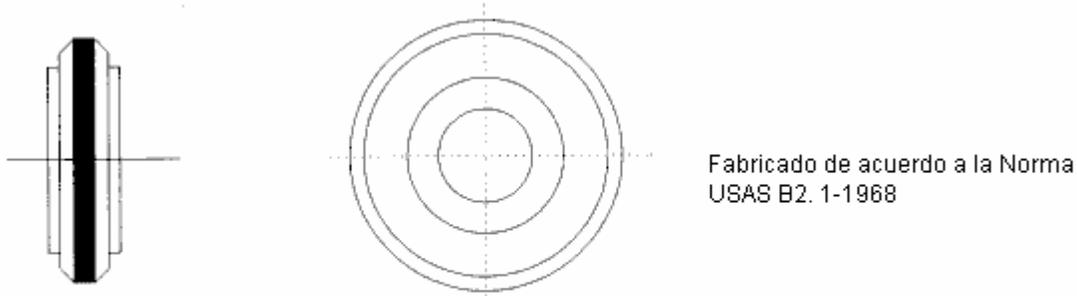
**Figura 4. Calibrador hembra**
